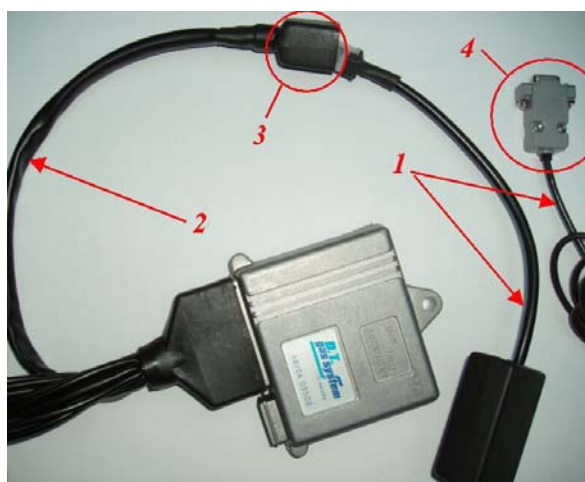
Rysunek 4.2b. Fotografia wiązki diagnostycznej sterownika DETEC Basic Plus: 1 – interfejs RS232, 2 – interfejs diagnostyczny sterownika wbudowany w wiązkę, 3 – złącze interfejsu sterownika, 4 – złącze komputerowe RS 232
