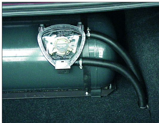
Rys. 2.39. Osłona hermetyczna osprzętu zespolonego wraz z przewodami przewietrzającymi
