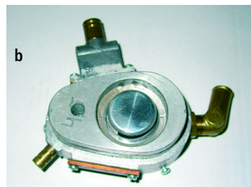
Rys. 3.1. Przepływomierze górno- i dolnośące oraz odpowiadające im mieszalniki
