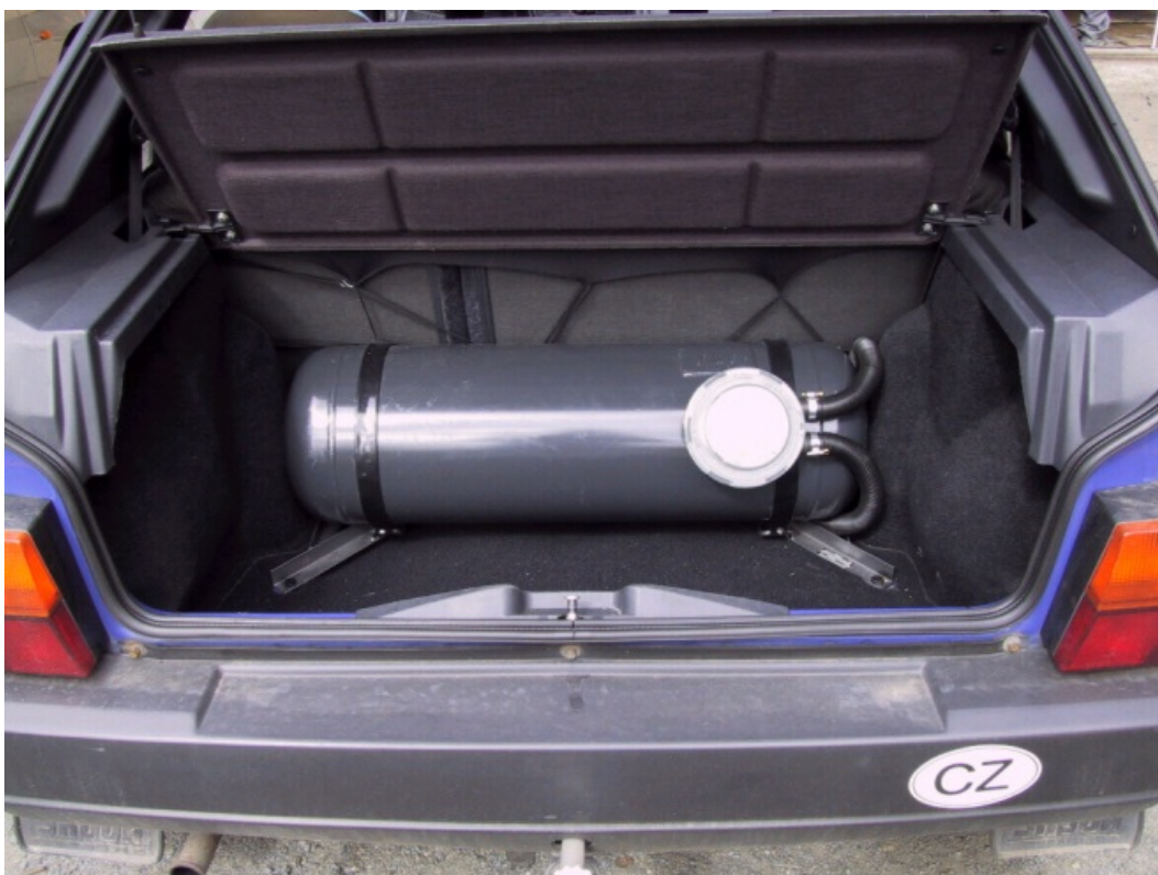
obr 4 umístění nádrže v zavazadlovém prostoru
