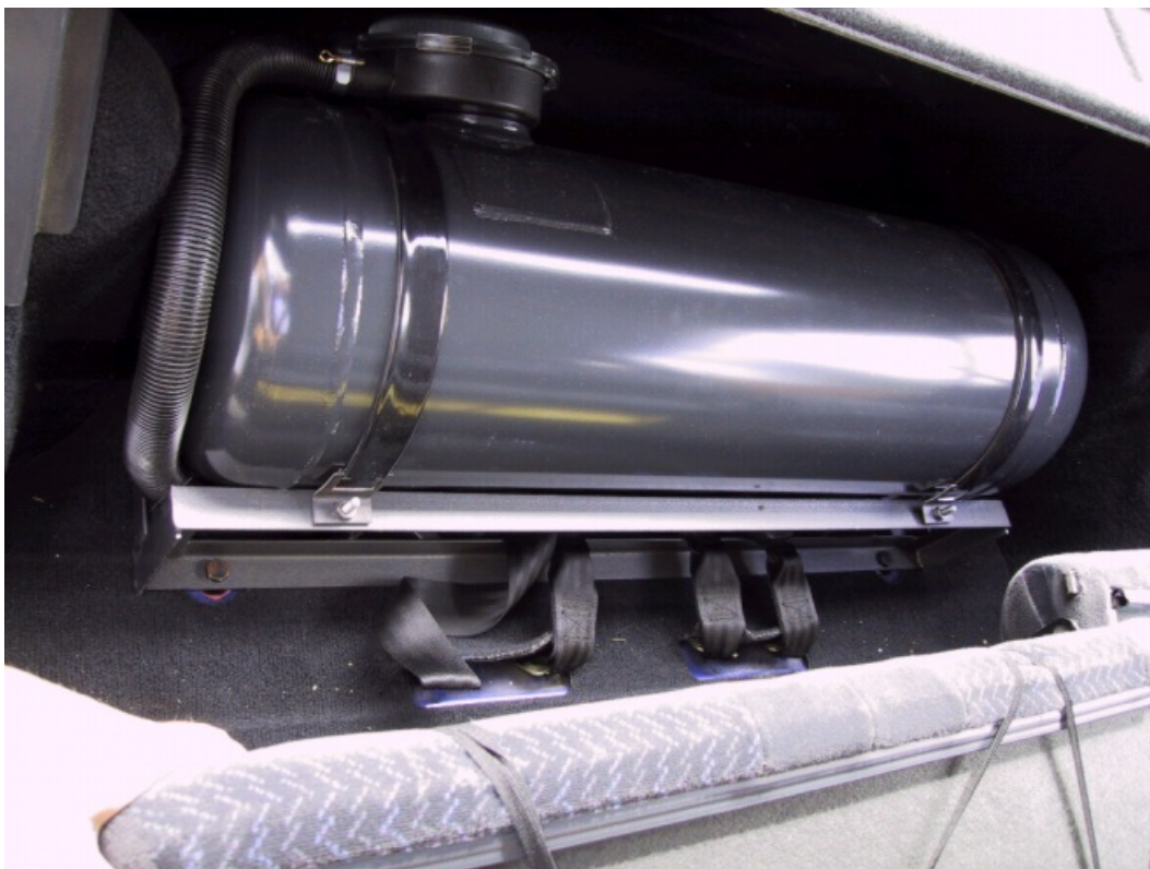
obr.3 Umístění nádrže v zavazadlovém prostoru
