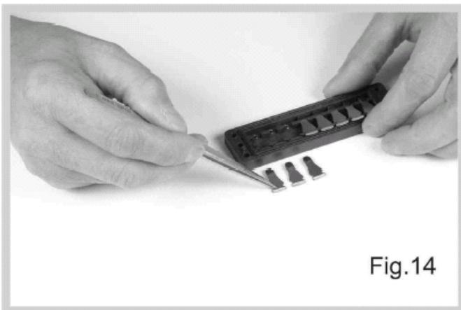
Voltar a colocar com cuidado e por ordem o vedante de estanquicidade externa, a lâmina e o anel em O linear.
