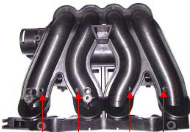
Furos Ø 4,7 mm roscados M6 para a instalação dos bicos de injeção GPL
