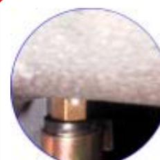
Bico de detecção do sinal M.A.P. do colector de aspiração
