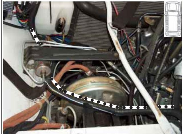
11. Harness leadthrough / Kabeldoorvoer /
