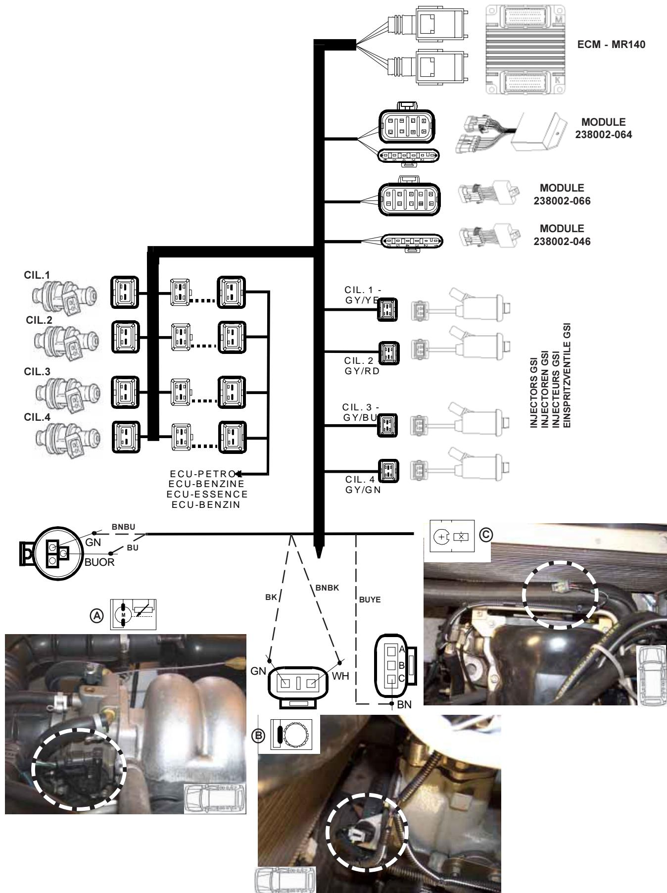
13a. Electrical connections / Electrische aansluitingen / Connexions électriques / Elektronische anschlüsse
