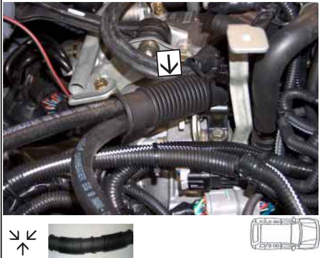
9. Mounting inletmanifold / Montage inlaatspruitstuk /
