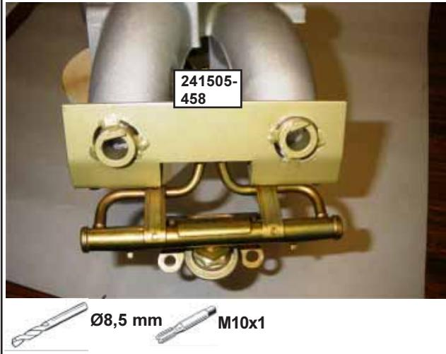
**2. Vacuum nipple / Vacuumnippel / Douille à dépression / Vakuumnippel**
