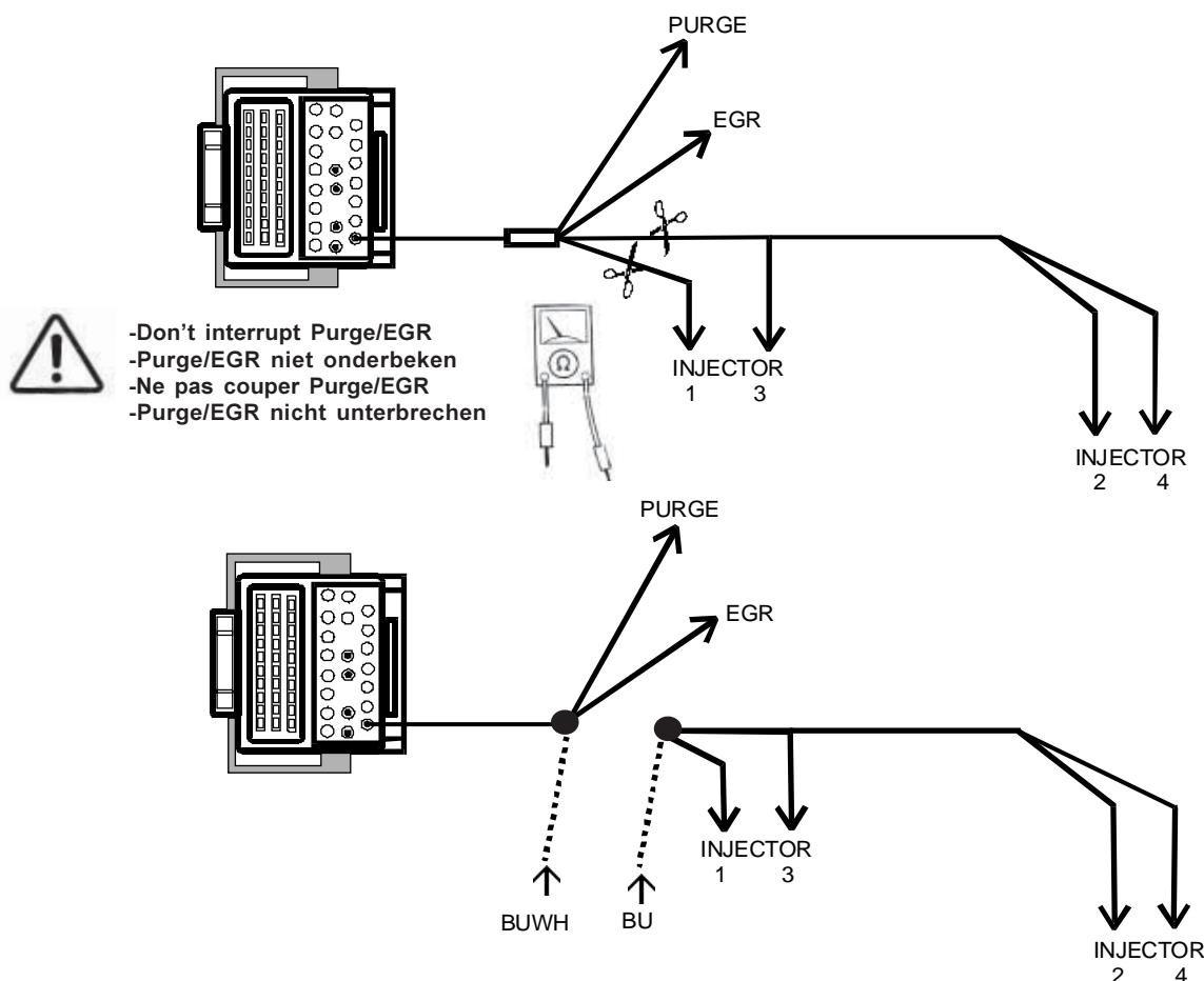
12b. Electrical connections / Electrische aansluitingen / Connexions électriques /Elektronische anschlüsse
