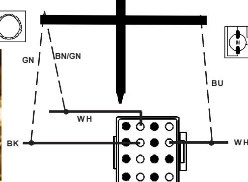
12a. Electrical connections / Electrische aansluitingen / Connexions électriques / Elektronische anschlüsse
