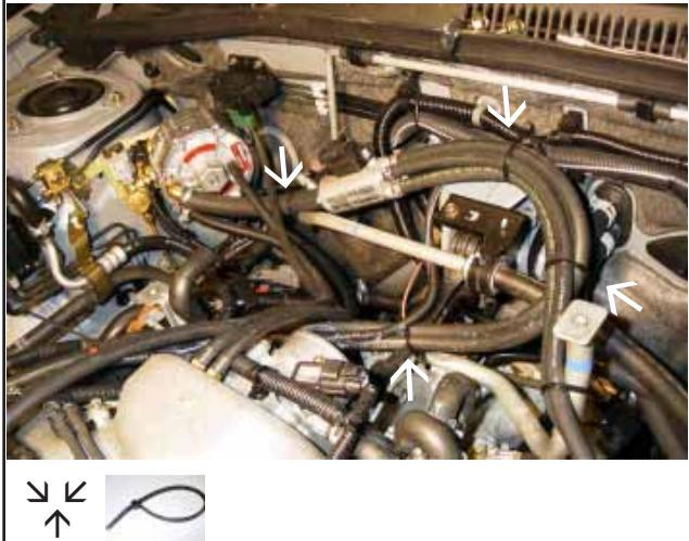
8. Harness leadthrough / Kabeldoorvoer /
