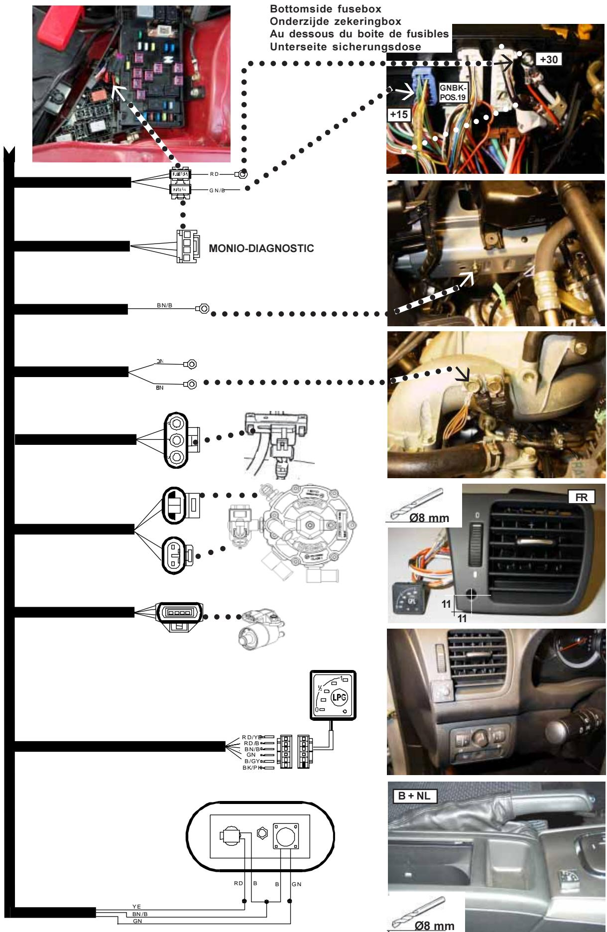
13. Electrical diagram / Electrisch schema / Schéma électrique / Elektronisches Schaltschema
