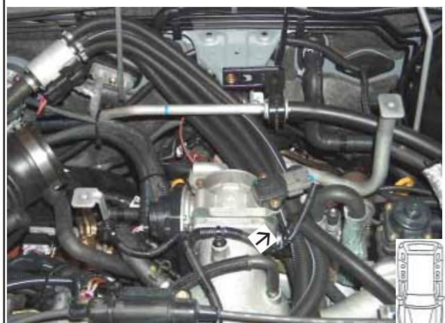
7. Harness leadthrough / Kabeldoorvoer /
