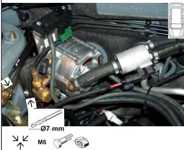
6. Mounting inletmanifold / Montage inlaatspruitstuk /
