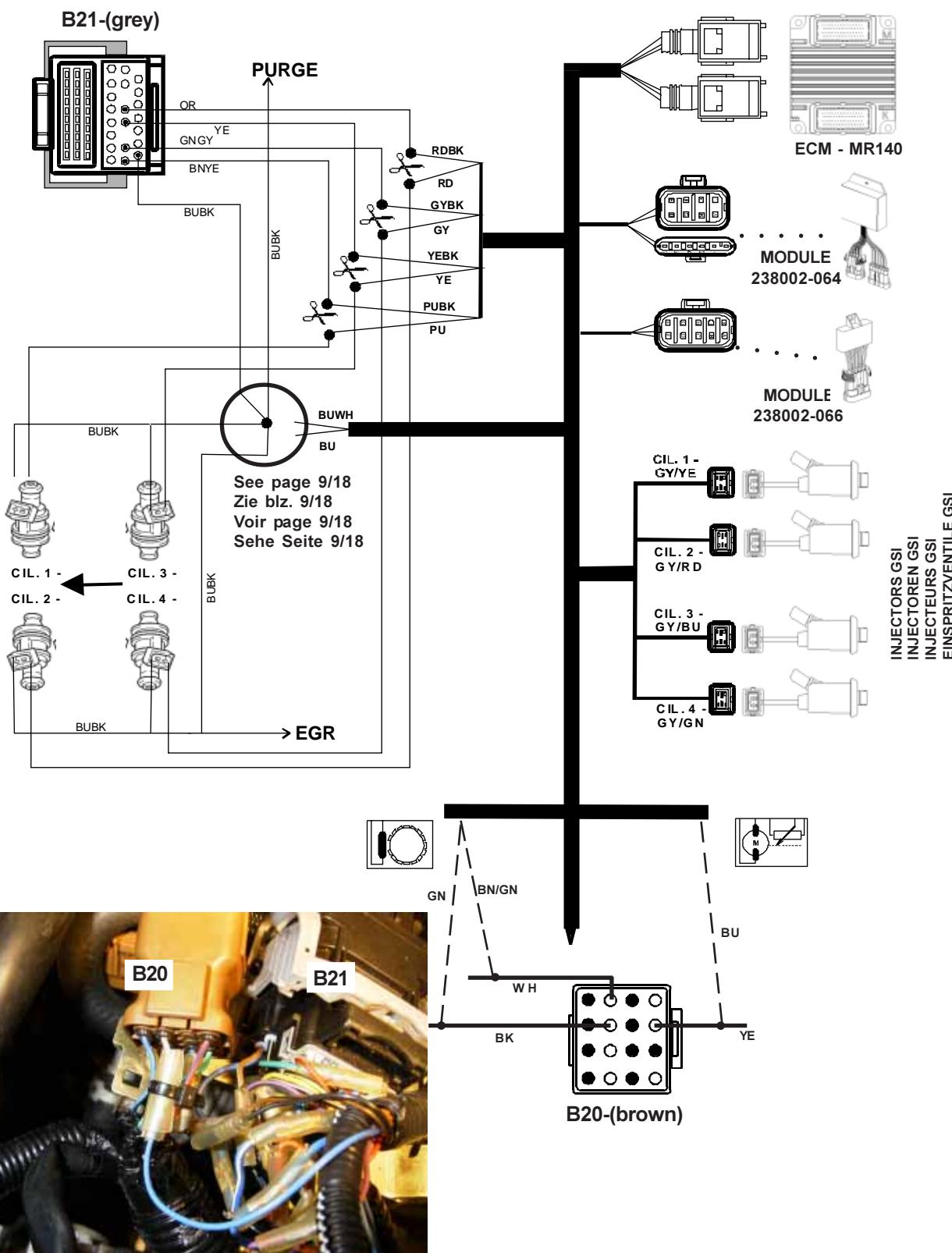
11a. Electrical connections / Electrische aansluitingen / Connexions électriques / Elektronische anschlässe
