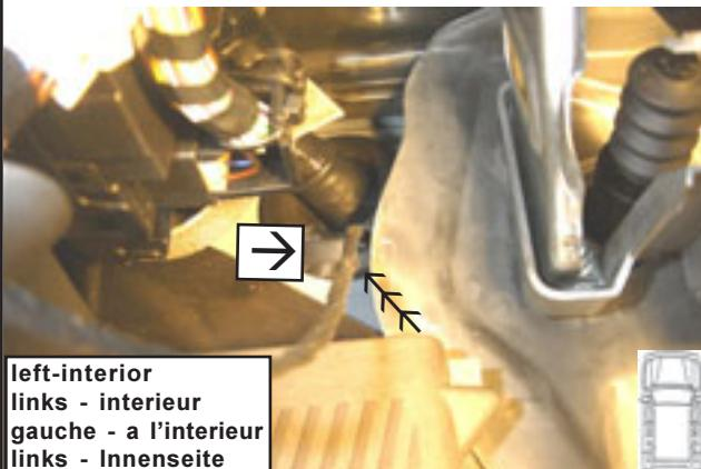
8. Mounting inletmanifold / Montage inlaatspruitstuk / Montage du collecteur d'admission / Montage Ansaugkrümmer
