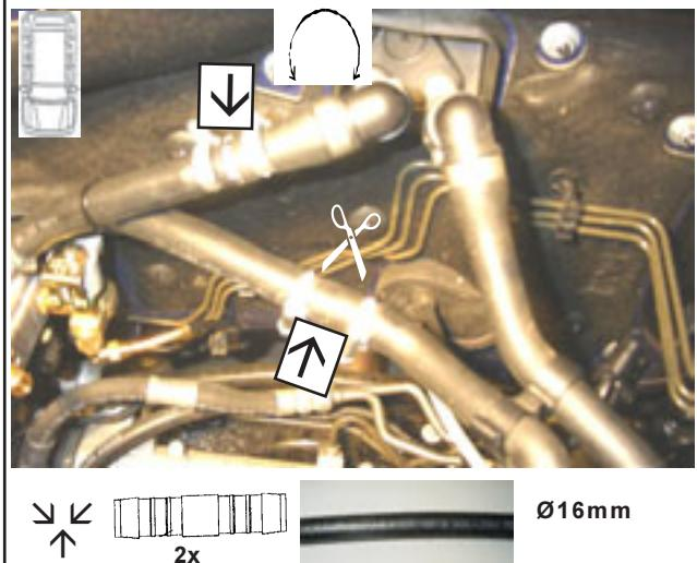
7. Harness leadthrough / Kabeldoorvoer / Passage de faisceau / Kabeldurchführung
