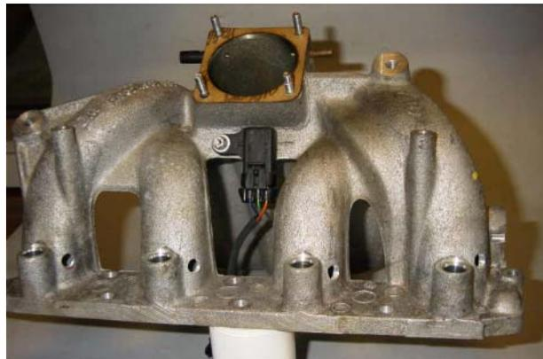
**2. Vacuum nipple / Vacuumnippel / Douille à dépression /
