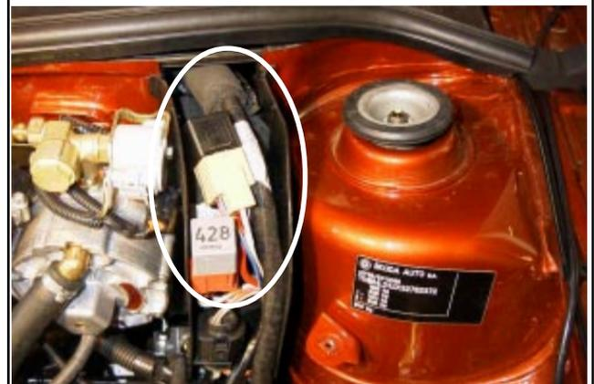
5. Harness leadthrough / Kabeldoorvoer /
