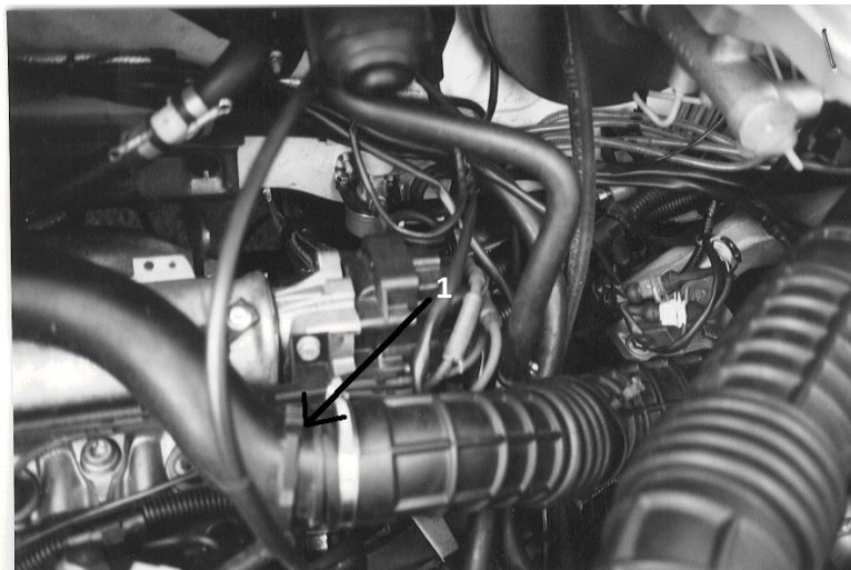
1) Punto in cui inserire l'anello freno aria per gli impianti a metano.
