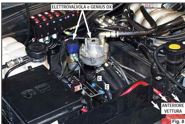
rame, unire l'uscita gas dell'elettrovalvola con l'ingresso gas del riduttore (vedi figura 6).
