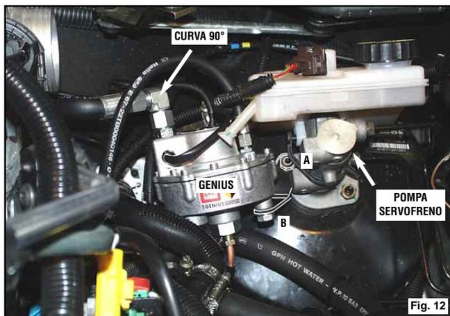
Utilizzando la curva 90° collegare sul riduttore la tubazione 10x17 già avvitata sul distributore. Rabboccare il livello del liquido raffreddamento motore ed eseguire uno spurgo del relativo impianto.
