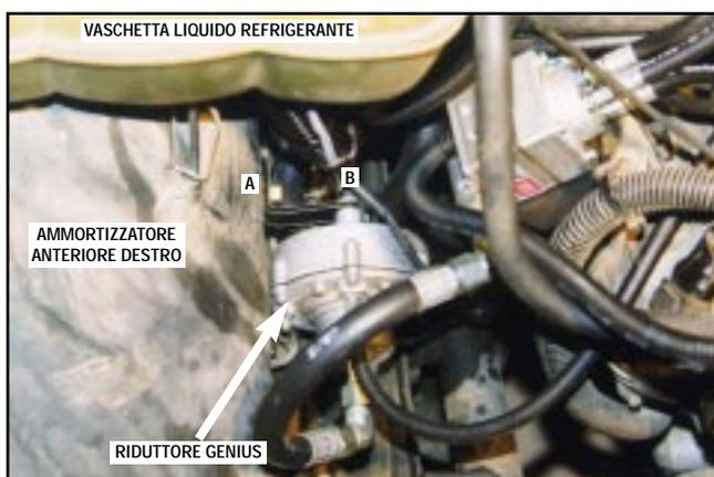
Chiudere le tubazioni con le fascette in dotazione. Raccordare alla parte posteriore del riduttore il tubo rame che deve risultare di una lunghezza sufficiente a raggiungere l'elettrovalvola.
