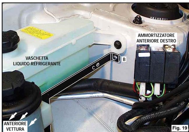
Mediante la colonnina distanziale  $h = 27$  mm e la vite TE M5x16 entrambi in dotazione, bloccare un'estremità della centralina Fly Gas al foro "C" della staffa di fissaggio (vedi figura 20 pagina seguente).
