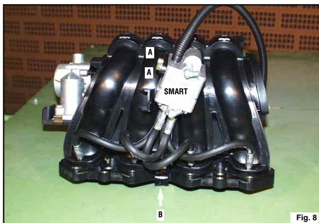
dentemente fissati (usare due chiavi e/o la chiave fornita in dotazione), raccordare sugli ugelli le 4 tubazioni, che dovranno essere collegate successivamente al distributore Smart.
