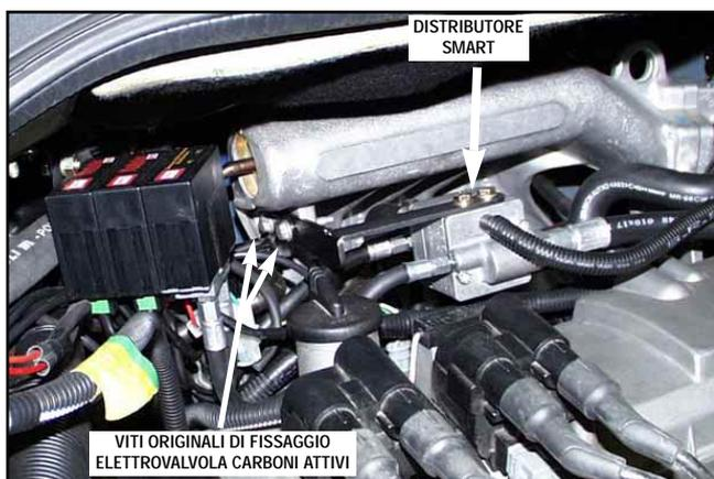
Avvitare infine sul distributore la tubazione di portata gas Riduttore/Distributore. Tale tubazione dovrà essere avvitata anche alla parte anteriore del riduttore, per mezzo della curva a 120° in dotazione.
