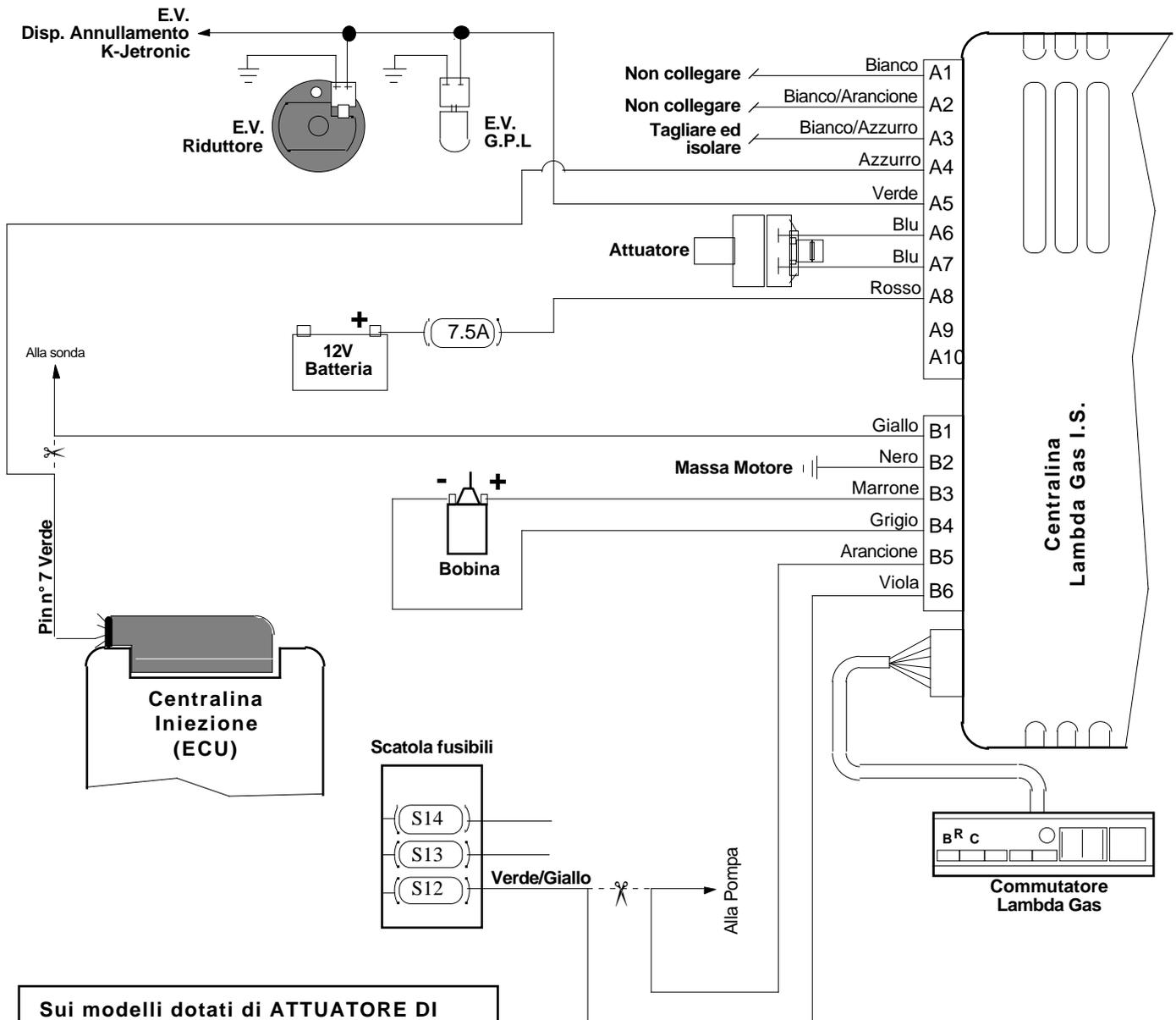
**Sui modelli dotati di ATTUATORE DI CONTROLLO PRESSIONE BENZINA interrompere il funzionamento dell'iniezione installando il dispositivo MODULAR K-J cod. 06LB 0000 3014 seguendo le istruzioni riportate nella confezione e di conseguenza non collegare i fili Arancione e Viola.**
