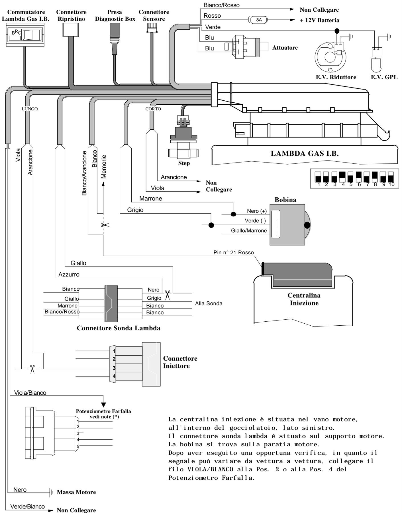
La centralina iniezione è situata nel vano motore, all'interno del gocciolatoio, lato sinistro. Il connettore sonda lambda è situato sul supporto motore. La bobina si trova sulla paratia motore. Dopo aver eseguito una opportuna verifica, in quanto il segnale può variare da vettura a vettura, collegare il filo VIOLA/BIANCO alla Pos. 2 o alla Pos. 4 del Potenziometro Farfalla.
