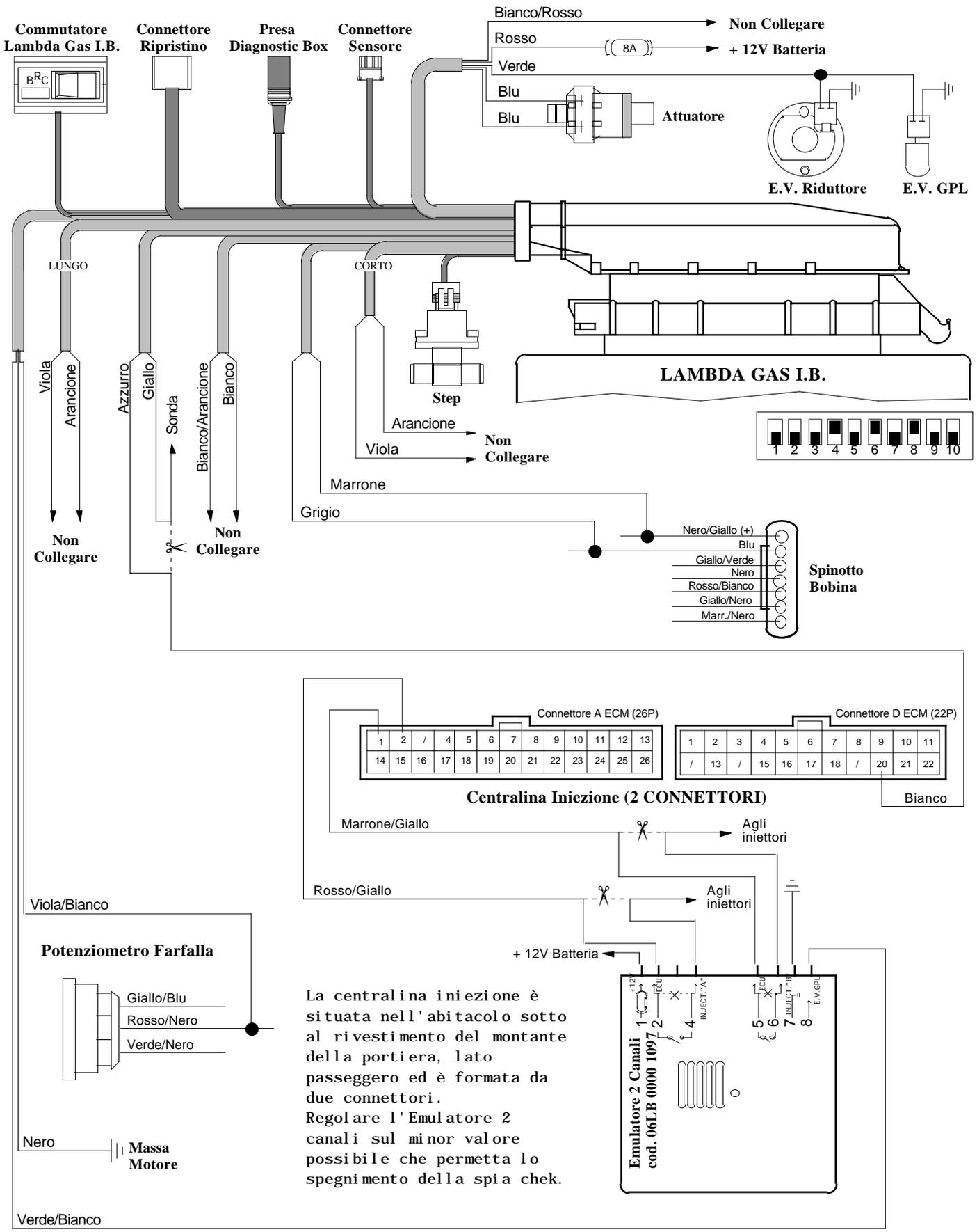
La centralina iniezione è situata nell'abitacolo sotto al rivestimento del montante della portiera, lato passeggero ed è formata da due connettori.
