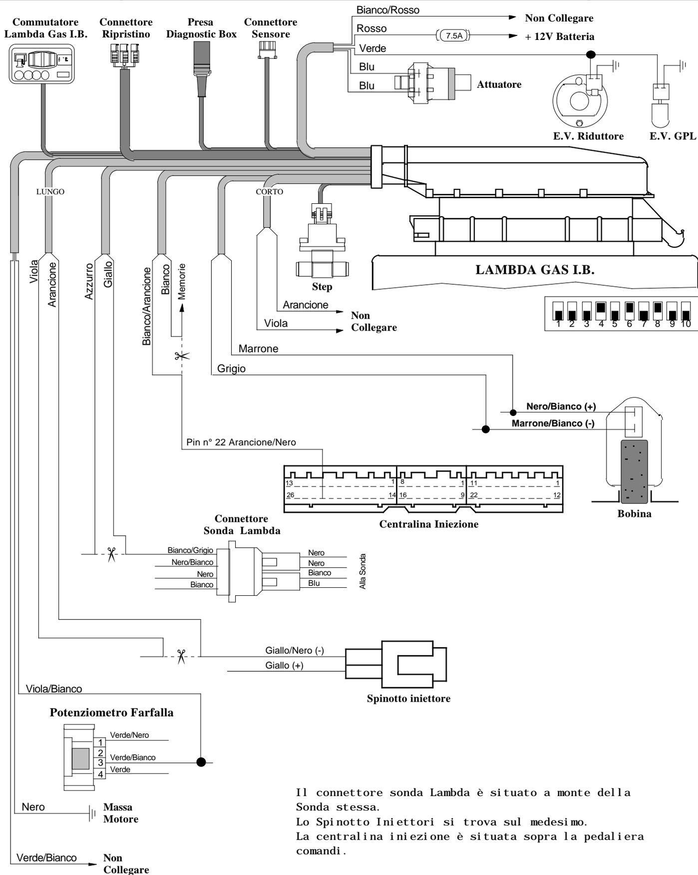
Il connettore sonda Lambda è situato a monte della Sonda stessa.
