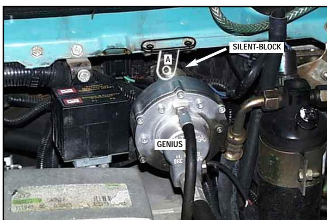
Facendo attenzione a non provocare un'eccessiva perdita d'acqua (usare allo scopo le pinze BRC cod. 90AV99004020) realizzare il circuito acqua riduttore utilizzando i due "T" 20x20x16. Inserire il primo "T" sulla mandata acqua riscaldamento abitacolo dopo l'uscita dal motore, sotto il disco servofreno.
