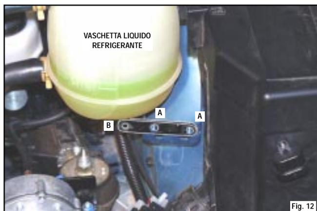
Infine bloccare i Modular HI al foro "B" della relativa staffa utilizzando la vite TE M6x16 presente nel kit (vedi figura 13).
