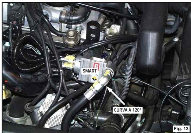
stire le quattro tubazioni dirette agli ugelli di adduzione gas con del tubo corrugato per evitare che si danneggino.
