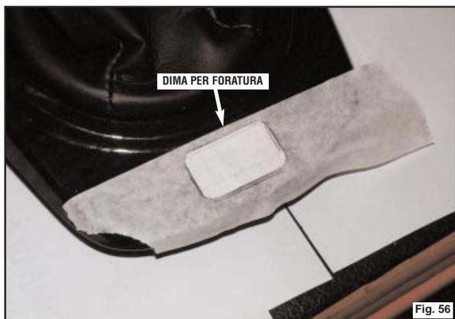
Svitare il pomello del cambio e smontare la plancia in plastica situata nella consolle centrale facendo attenzione ai connettori collegati. Utilizzando del nastro adesivo, segnare dove praticare il foro per il commutatore. Utilizzare quindi l'attrezzo di foratura sede commutatore cod. 90AV99000043 (fig. 56).
