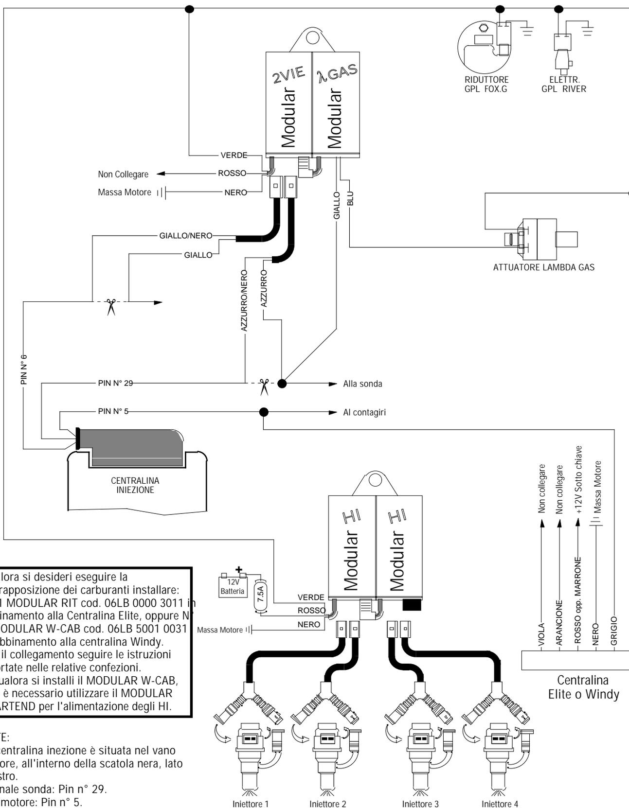
Qualora si desideri eseguire la sovrapposizione dei carburanti installare: N° 1 MODULAR RIT cod. 06LB 0000 3011 in abbinamento alla Centralina Elite, oppure N° 1 MODULAR W-CAB cod. 06LB 5001 0031 in abbinamento alla centralina Windy. Per il collegamento seguire le istruzioni riportate nelle relative confezioni.
