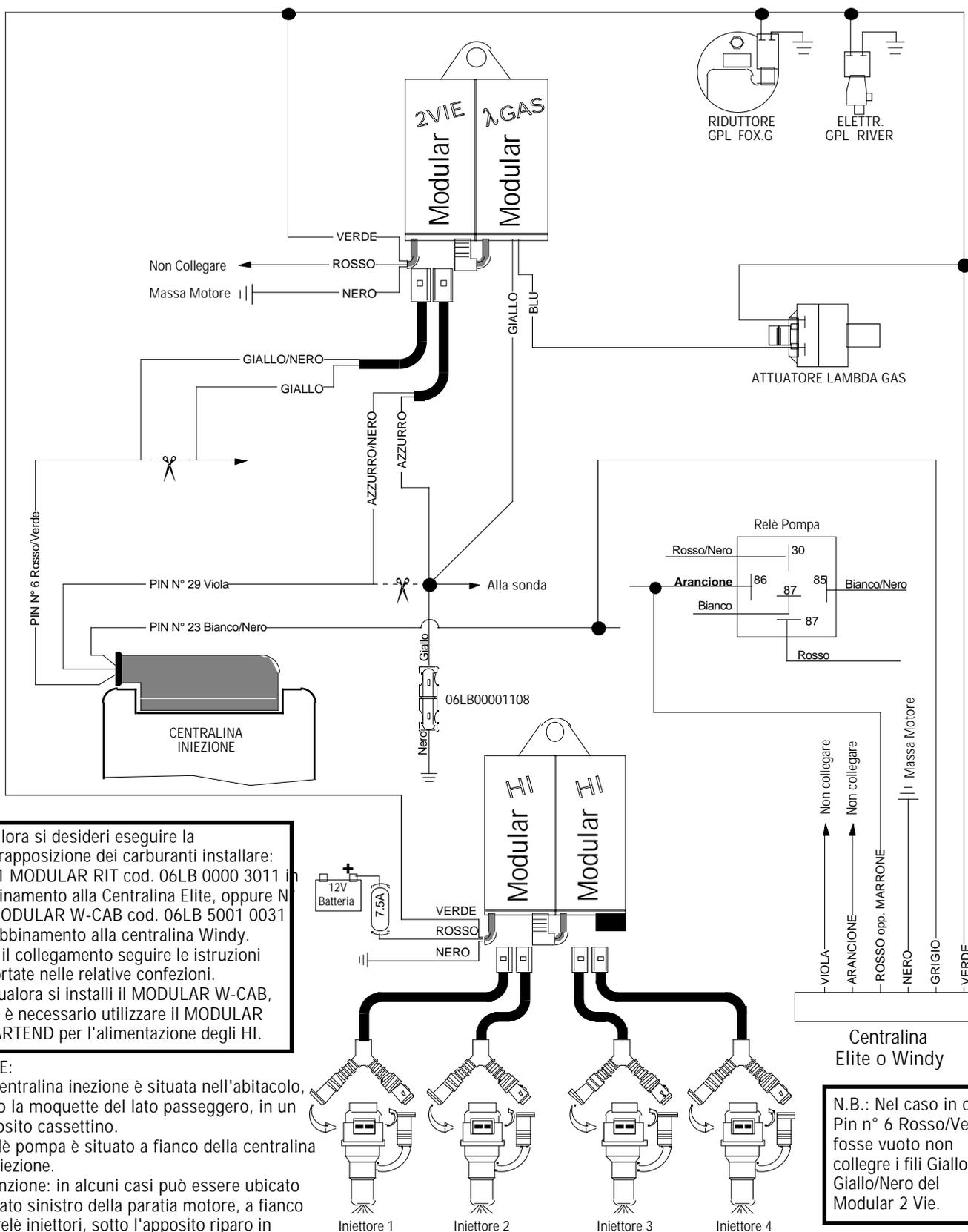
Qualora si desideri eseguire la sovrapposizione dei carburanti installare: N° 1 MODULAR RIT cod. 06LB 0000 3011 in abbinamento alla Centralina Elite, oppure N° 1 MODULAR W-CAB cod. 06LB 5001 0031 in abbinamento alla centralina Windy. Per il collegamento seguire le istruzioni riportate nelle relative confezioni. \* Qualora si installi il MODULAR W-CAB, non è necessario utilizzare il MODULAR STARTEND per l'alimentazione degli HI.
