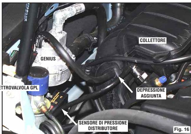
ritorno riscaldamento abitacolo in misura sufficiente al collegamento sul Genius (vedi fig. 14). Inserire sul tubo rimasto attaccato al motore la giunzione 16-16, quindi raccordare tra Genius e giunzione il tubo acqua in dotazione.
