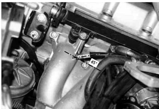
mente fissati (usare sempre due chiavi e/o la chiave fornita in dotazione), raccordare sugli ugelli le quattro tubazioni (riconoscibili in quanto di pari lunghezza), che dovranno essere collegate successivamente al distributore Smart.
