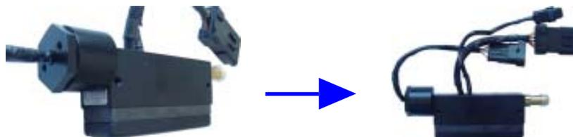
Selezionare gli ugelli da installare sul gruppo elettroiniezione in base alla potenza della vettura. Esistono diverse grandezze di ugello: Ø 2,4, Ø 2,7, Ø 3,2 e Ø 3,5. Per la determinazione del tipo di ugello consultare la seguente tabella.
