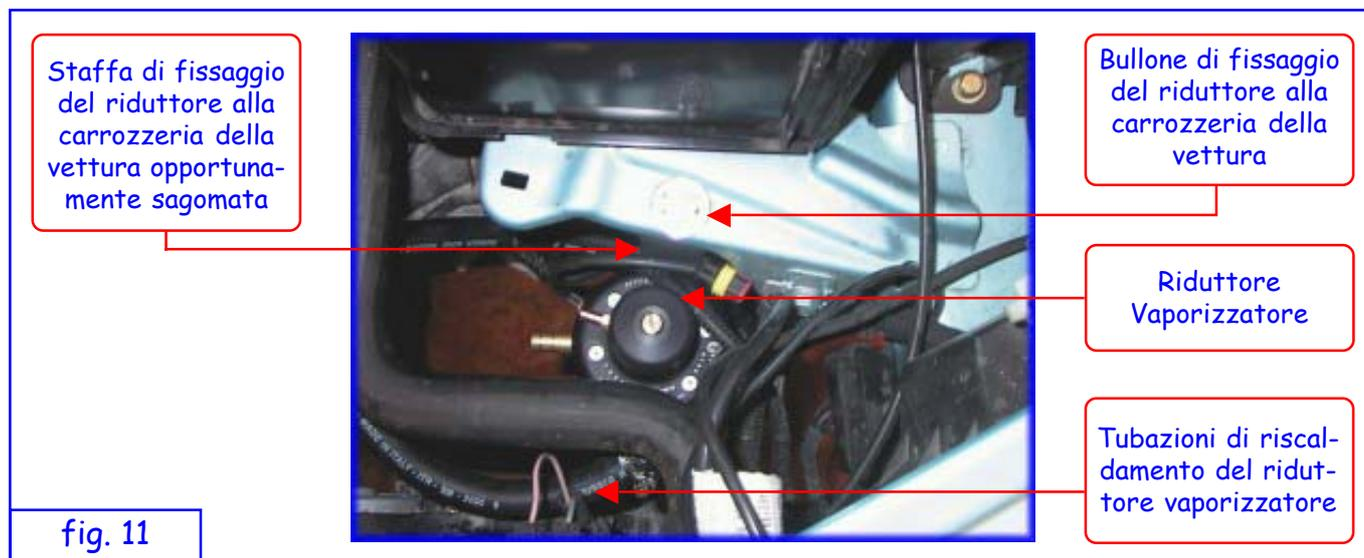
Il riduttore deve essere montato in posizione verticale (vedi paragrafo 4.2) in modo tale che la vite di registro della pressione di riduzione sia facilmente raggiungibile e che il raccordo di uscita del GPL, l'ugello MAP, la valvola di sovrappressione e le pipe acqua siano orientati al meglio verso i relativi componenti evitando il contatto con parti in movimento od eventualmente calde della vettura.
