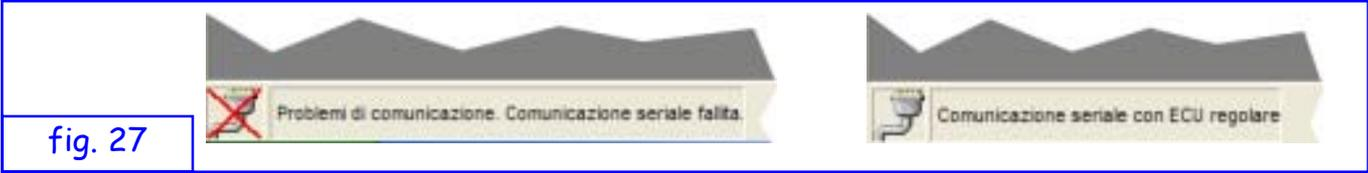
Viene inoltre verificata la compatibilità tra la versione software (programma aperto sul computer) ed il firmware (programma caricato nella centralina). Se le due versioni non sono compatibili viene visualizzato il messaggio di errore di figura 28. Cliccando su SI il software chiude la versione non compatibile e apre la versione compatibile con il programma residente nella centralina.
