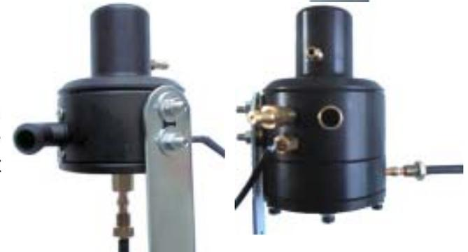
Le groupe détendeur-bride doit être fixé à la carrosserie de la voiture à l'endroit choisi en utilisant la vis M10x20 (7) et l'écrou hexagonal M10 (8) (voir figure 11).
