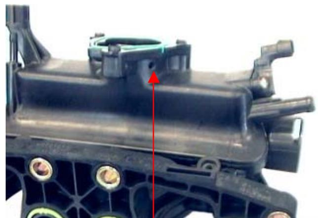
Trou Ø 4,7 mm fileté M6 pour l'installation de la sonde de pression M.A.P.
