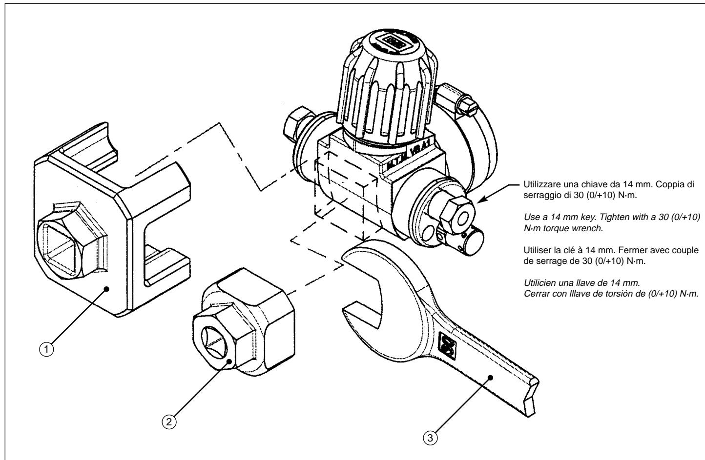
Per il serraggio della valvola bombola Metano tipo VBA1 è necessario utilizzare una delle tre chiavi di serraggio indicate in figura.
