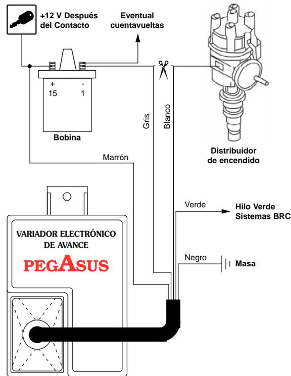
**ATENCIÓN:** Controlar que sobre el positivo de la bobina no esté la resistencia, si lo está, coger el +12 V Después del Contacto de otra posición.
