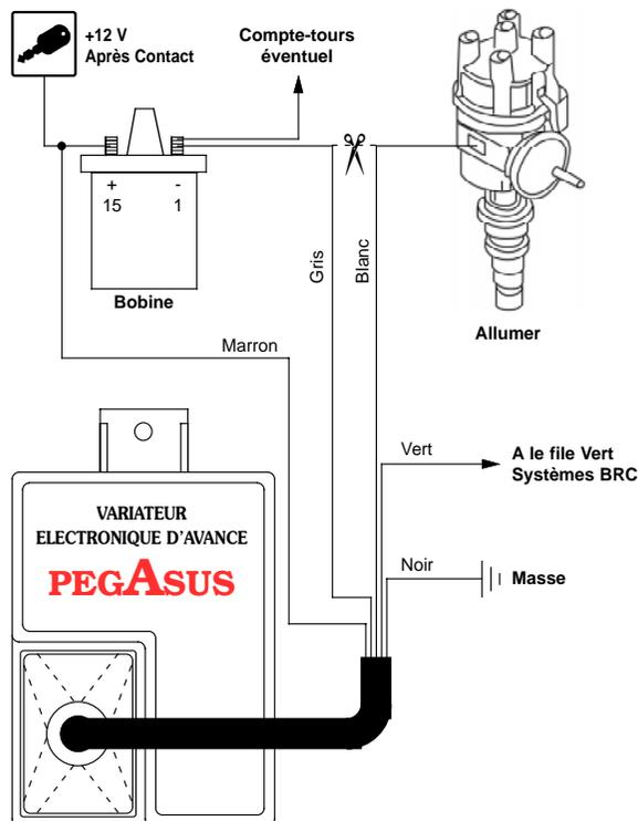
**ATTENTION:** Contrôlez que la résistance ne soit pas sur le positif de la bobine, sinon prélevez le +12 V après contact dans une position.
