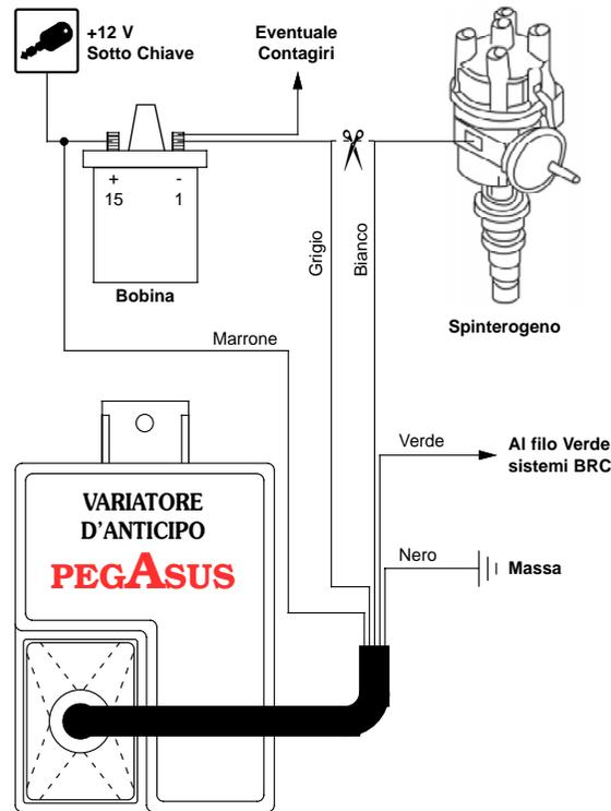
**ATTENZIONE:** Verificare che sul positivo della bobina non ci sia la resistenza, altrimenti prelevare il +12 V sotto chiave in un'altra posizione.
