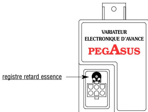
connecteur du variateur, ramenez l'avance à sa valeur initiale; 3) Ce réglage ne modifie pas le réglage fait précédemment au GAZ. 4) Avant d'installer le variateur il est aussi conseillé de vérifier la propreté des vis platinées et les contacts en parfaites conditions. Des vis platinées en mauvais état peuvent provoquer des arrêts du moteur ou des ratés.
